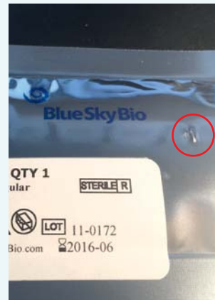
Abb.50 Durch scharfkantige Abdeckschraube verletzte Sterilverpackung (BlueSkyBio)
