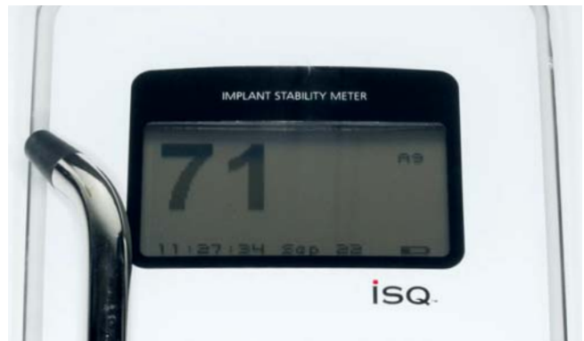
Abb. 10 Messung der Primärstabilität mittels Osstell ISQ-Meter
